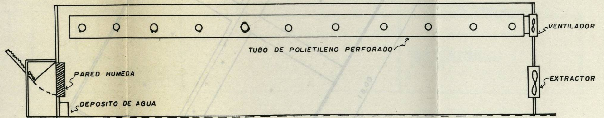
CORTE LONGITUDINAL INVERNADERO 2 ESC. 1:75
