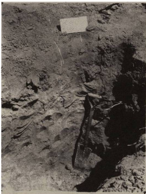
Figura 2.- Perfil de 1.5 m., en el cual se observa que no hay estratos bien marcados.
