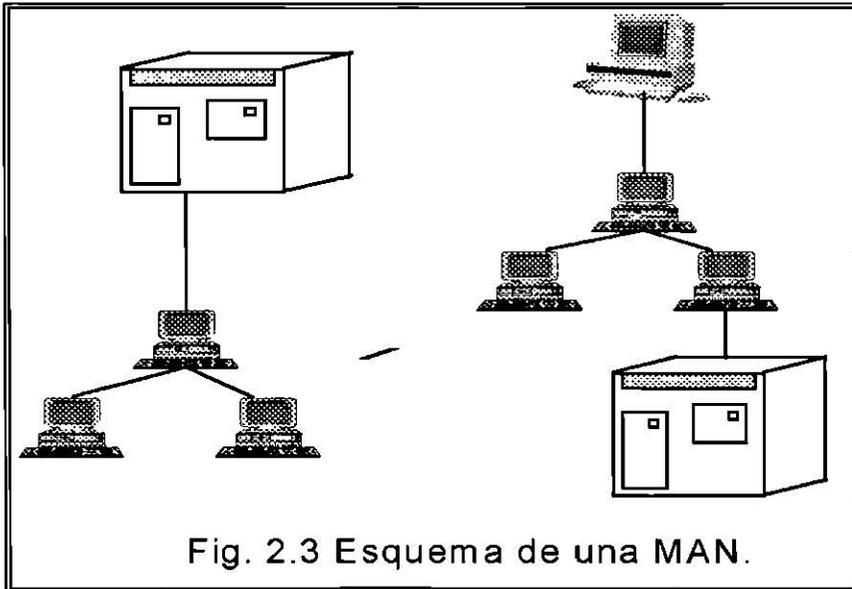
Fig. 2.3 Esquema de una MAN.
