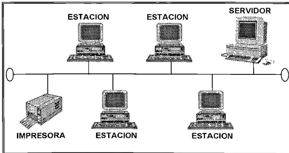
Fig. 2.2 Esquema de una LAN
