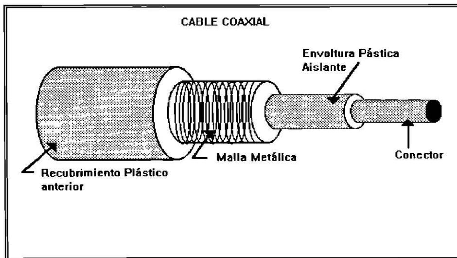
Fig. 4.1 Vista Lateral de un Cable Coaxial.
