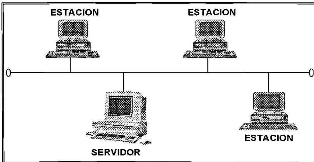
Fig. 2.1 Esquema de una red de área local.
