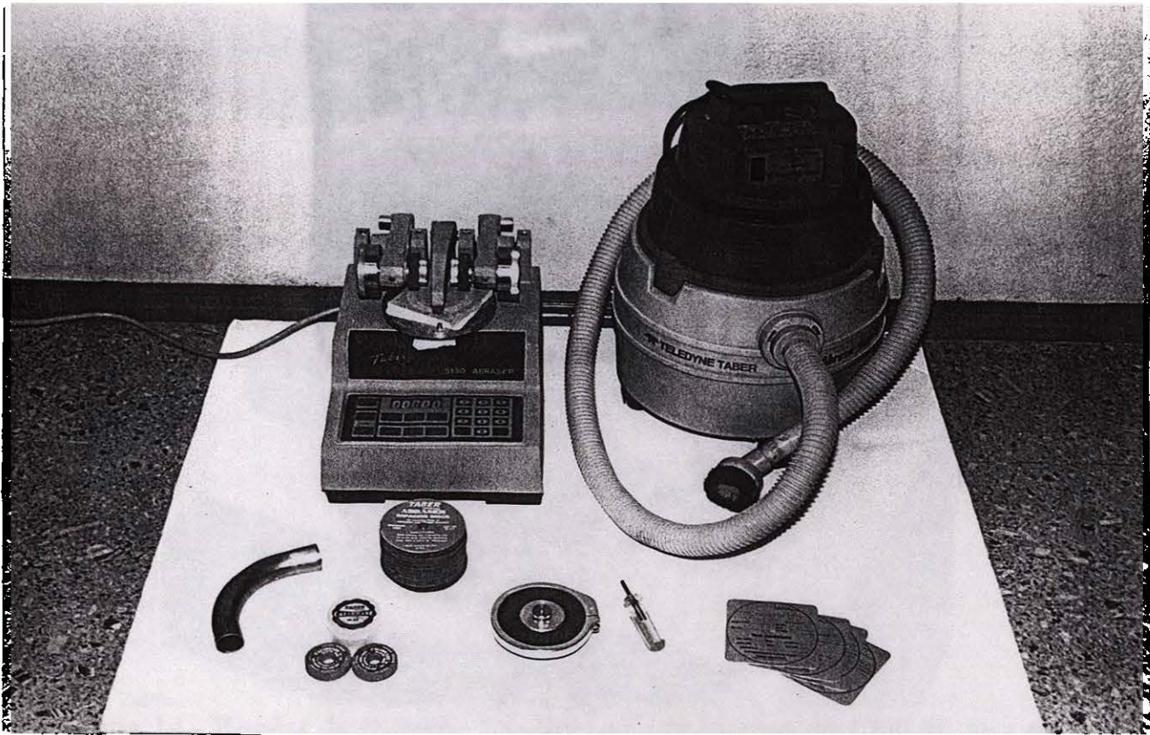
Fotografía 11.- Componentes del Mod. 5130 para pruebas de abrasión.
