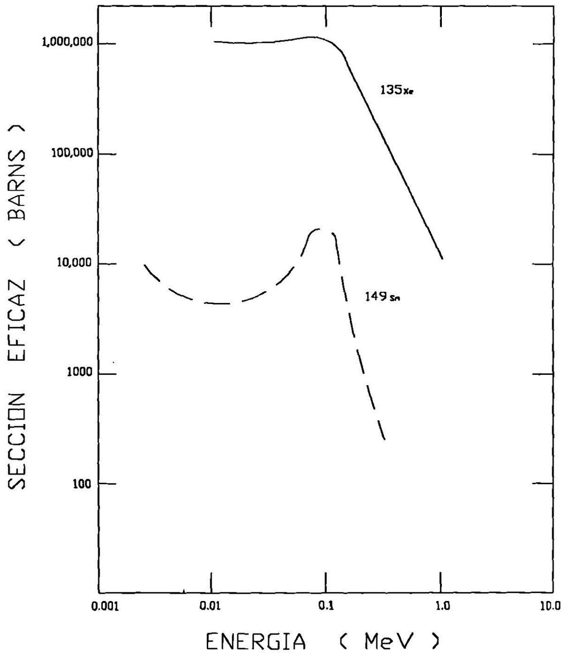
FIGURA 11 SECCION EFICAZ DE XENDON-135 Y DEL SAMARIO-149
