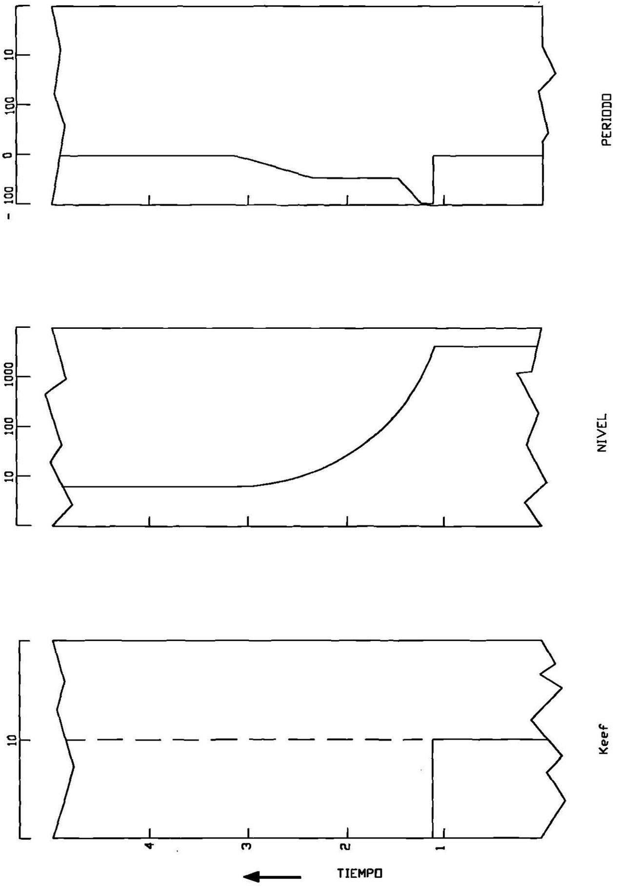
FIGURA 5 APAGADO DEL REACTOR MEDIANTE UN SCRAM
