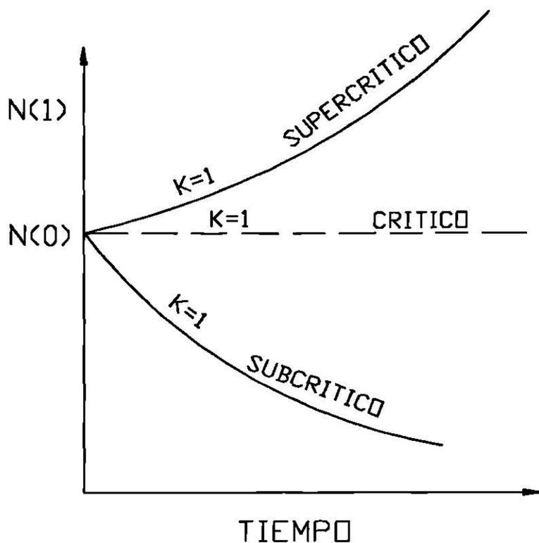
FIGURA 2 COMPORTAMIENTO DE LA POBLACION DE NEUTRONES EN UN REACTOR.
