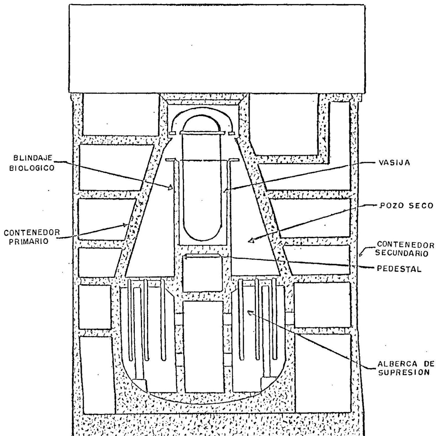
Figura No.1 SISTEMA DE CONTENCIÓN DE UN REACTOR
