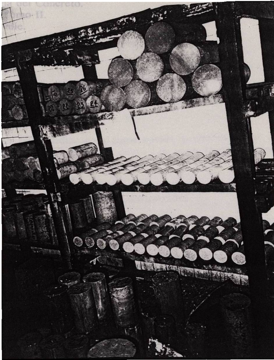
Fotografía 10. Curado de especímenes de suelo-cemento según norma ASTM1632
