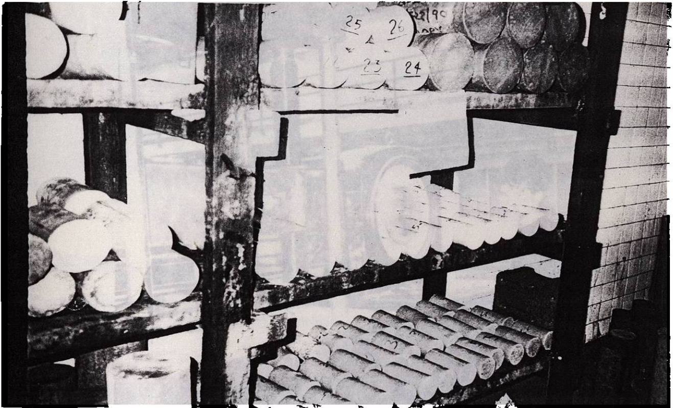
Fotografía 1. Curado estándar norma ASTM1632 de especímenes de suelo-cemento
