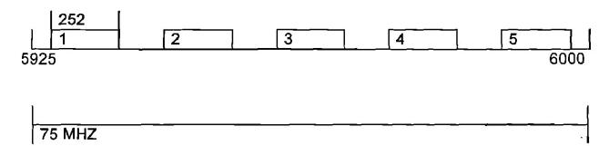
En seguida vamos a sacar analíticamente el AB de cada uno de los 5 enlaces utilizados en este repetidor ( REP. 1 ).
