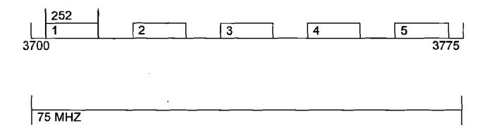
Siguiendo el plan de frecuencia en el enlace ascendente tenemos que cada enlace tiene un AB de 12.5 MHZ y guardas 1.25 MHZ por canal.
