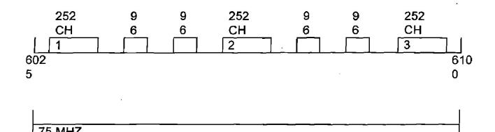
En seguida sacaremos analíticamente el AB para cada uno de los 4 enlaces de 96 canales del REP. 2. Respetando las condiciones para los enlaces de 252 canales.
