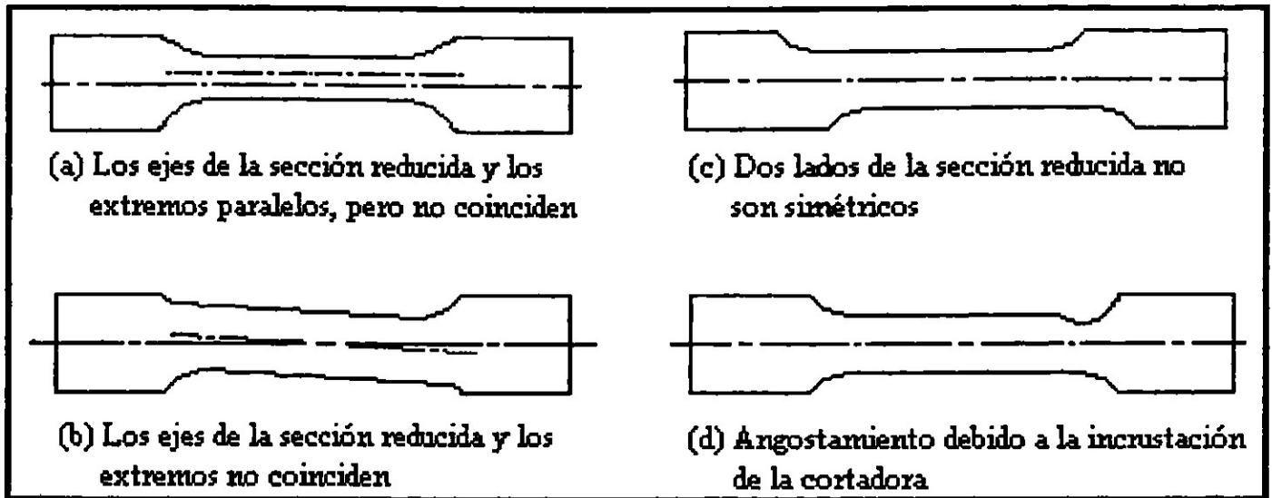
Figura 3.8 Defectos comunes en las probetas planas
