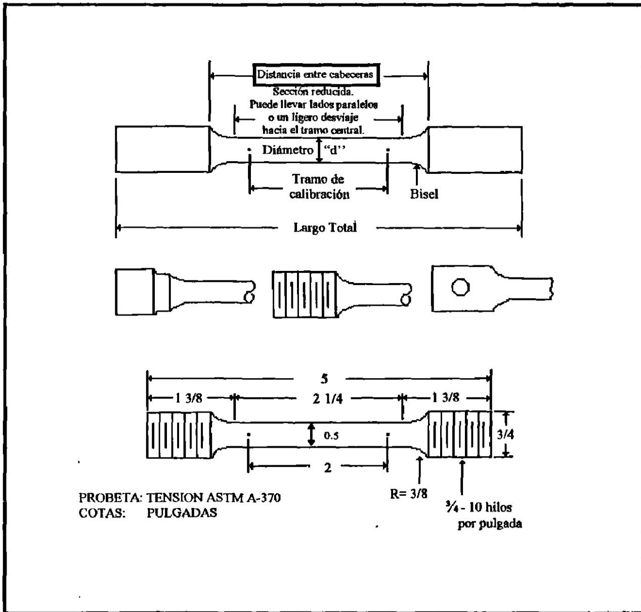
Figura 3.7 Tipos de extremos para probetas de tensión
