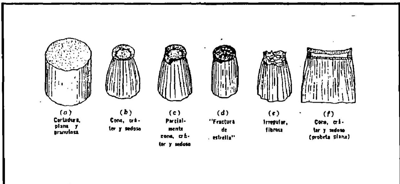
Figura 3.13 Fracturas típicas por tensión en metales.
