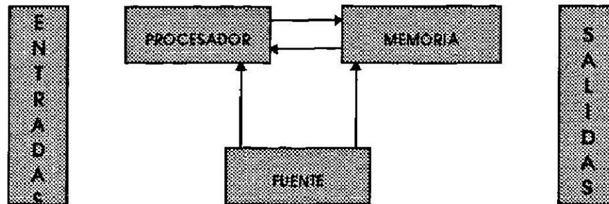
El término CPU encierra todos los elementos necesarios para formar la inteligencia del sistema. El procesador ejecuta el programa almacenado en la memoria en forma de diagrama escalera, el cual es muy similar al diagrama utilizado en los controles por relevación, mientras que la fuente proporciona los voltajes necesarios para la operación apropiada de todos los componentes .
