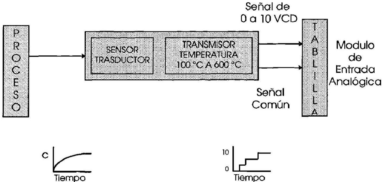
Las interfaces analógicas están disponibles en rangos de voltaje unipolares (solo voltaje positivo) y bipolares (voltaje positivo y negativo).
