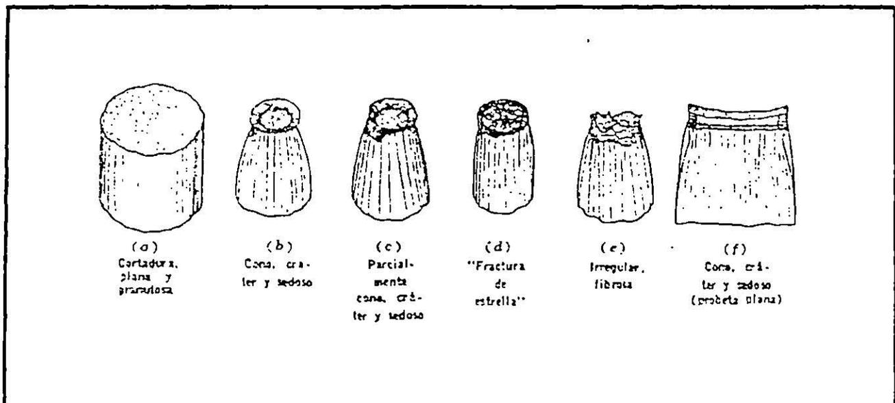
Figura 3.13 Fracturas típicas por tensión en metales.
