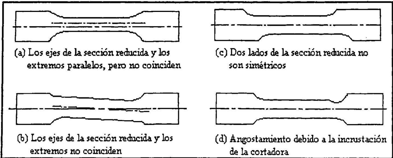
Figura 3.8 Defectos comunes en las probetas planas
