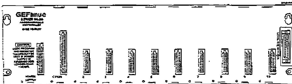
Figura 2-2. Placa Base de la CPU del PLC Serie 90-30 del Modelo 331
