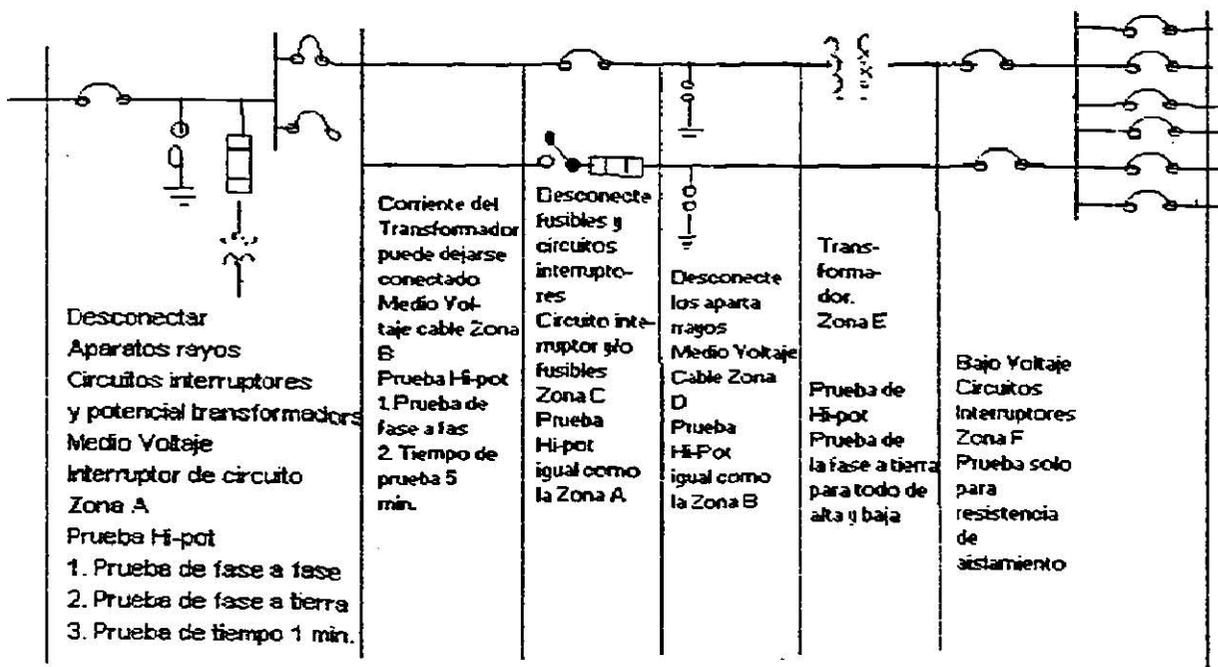
Fig. 2.8 Prueba de alta potencia para cables y equipos asociados y equipos a desconectar durante la prueba.
