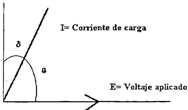
El aislamiento del factor de potencia es una herramienta importante para determinar la calidad del aislamiento para transformadores, interruptores, máquinas giratorias, cables, reguladores y líquidos aislantes. Varias precauciones deberán tomarse en cuenta cuando se hace una prueba de factor de potencia.
