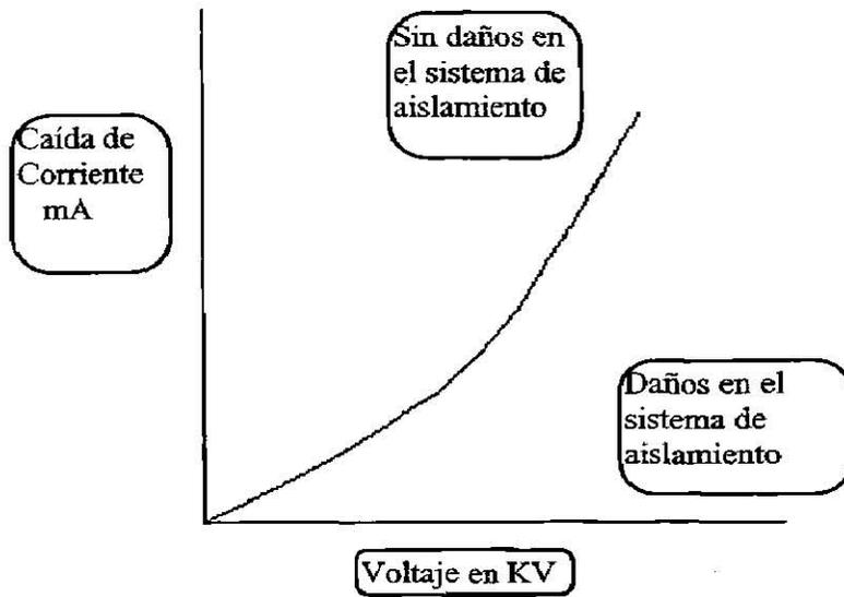
FIGURA 2.6 PASO DE VOLTAJE ALTO-POTENCIAL PRUEBA DE CORRIENTE
