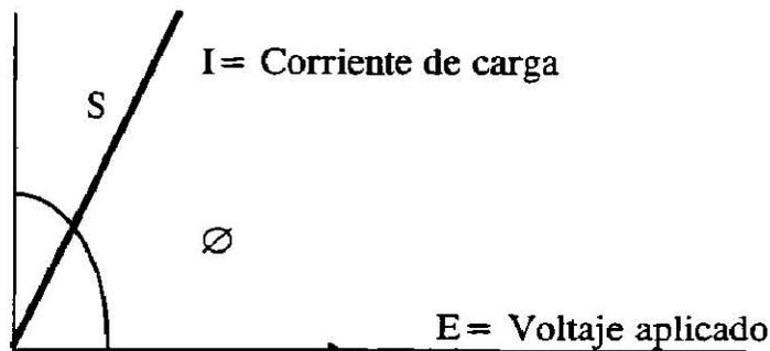
El aislamiento del factor de potencia es una herramienta importante para determinar la calidad del aislamiento para transformadores, interruptores, máquinas giratorias, cables, reguladores y líquidos aislantes. Varias precauciones deberán tomarse en cuenta cuando se hace una prueba de factor de potencia.
