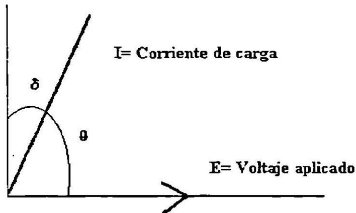
El aislamiento del factor de potencia es una herramienta importante para determinar la calidad del aislamiento para transformadores, interruptores, máquinas giratorias, cables, reguladores y líquidos aislantes. Varias precauciones deberán tomarse en cuenta cuando se hace una prueba de factor de potencia.
