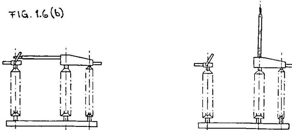
CUCHILLA DESCONECTADORA DE TRES COLUMNAS
