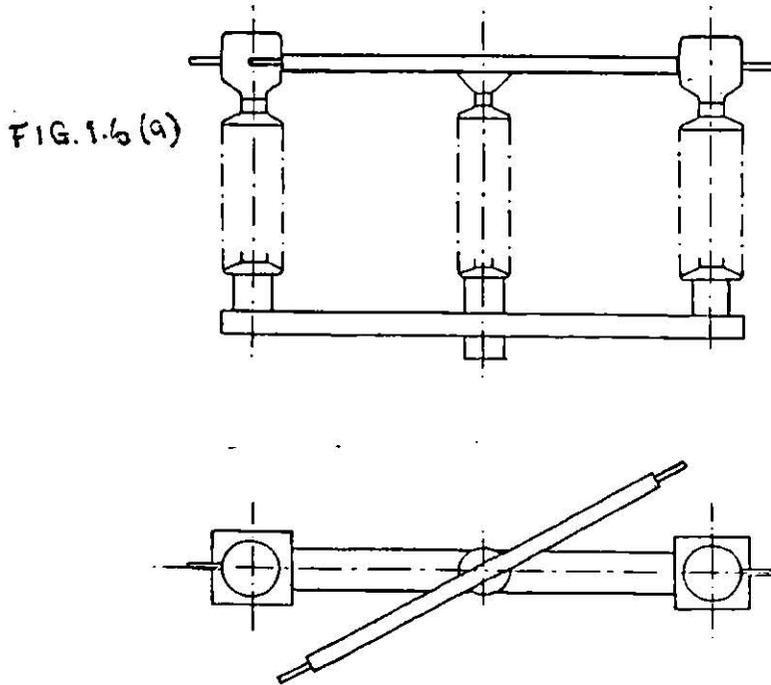
CUCHILLA DESCONECTADORA DE TRES COLUMNAS
