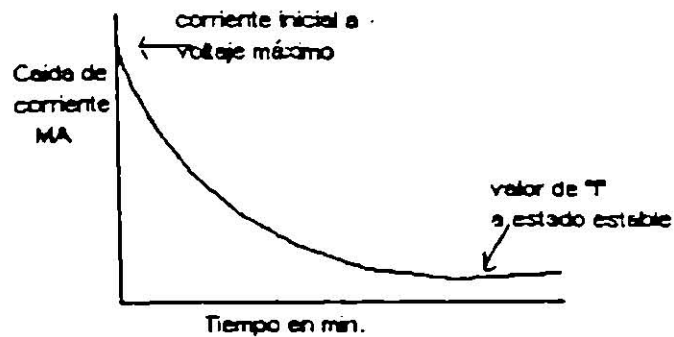
fig. 2.6 Caída de corriente contra tiempo
