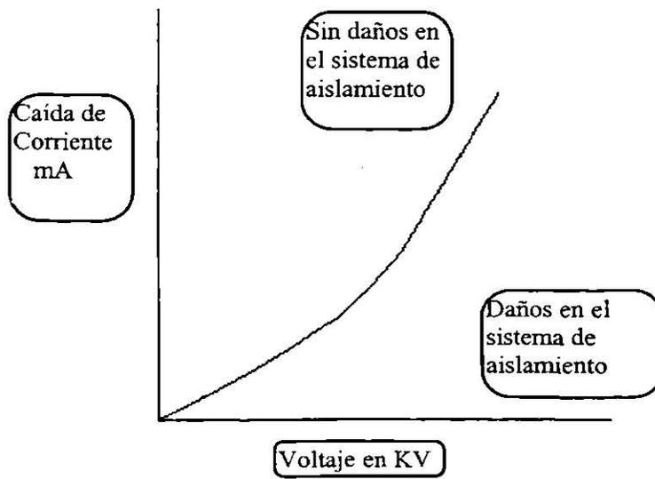
FIGURA 2.6 PASO DE VOLTAJE ALTO-POTENCIAL PRUEBA DE CORRIENTE
