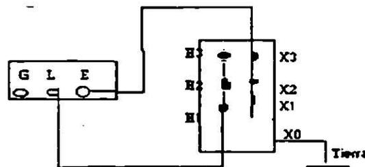
Fig. 2.2 Conexiones de prueba para resistencia de aislamiento para transformadores trifásicos. (a) Conexión de bobina de alta a bobina de baja a tierra; (b) Conexión para bobina de alta a tierra y bobina de alta protegida; (c) Conexión de bobina de baja a bobina de alta a tierra; (d) Conexión de bobina de baja a tierra y bobina de alta y protegida; (e) Conexión de bobina de alta a bobina de baja.
