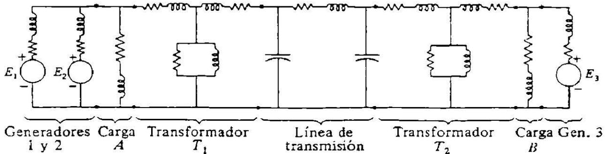
El diagrama de impedancias no incluye las impedancias limitadoras de corriente, que se ven en el unifilar entre los neutros de los generadores y tierra, porque en condiciones de equilibrio, no circulan corrientes por la tierra y neutros de los generadores están al mismo potencial que el neutro del sistema.
