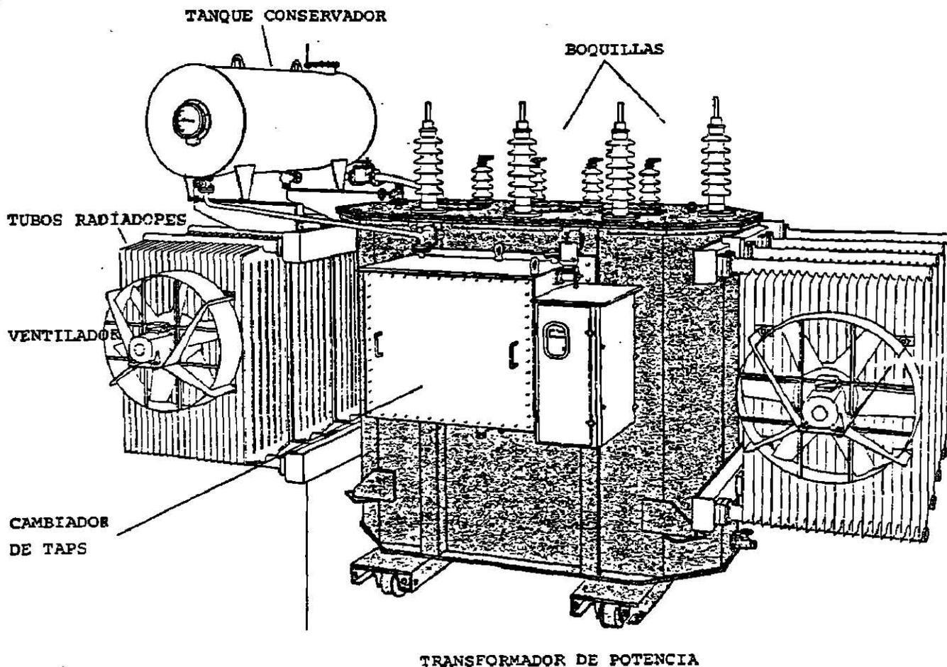
La capacidad de sobrecarga de un transformador, es función de su capacidad de disipación de calor, o sea que en cualquier situación de operación, un transformador se puede sobrecargar sobre su capacidad nominal por un cierto periodo de tiempo. Por ejemplo, para transformadores de distribución sumergidos en aceite, la norma ANSI C57.96, da los siguientes valores:
