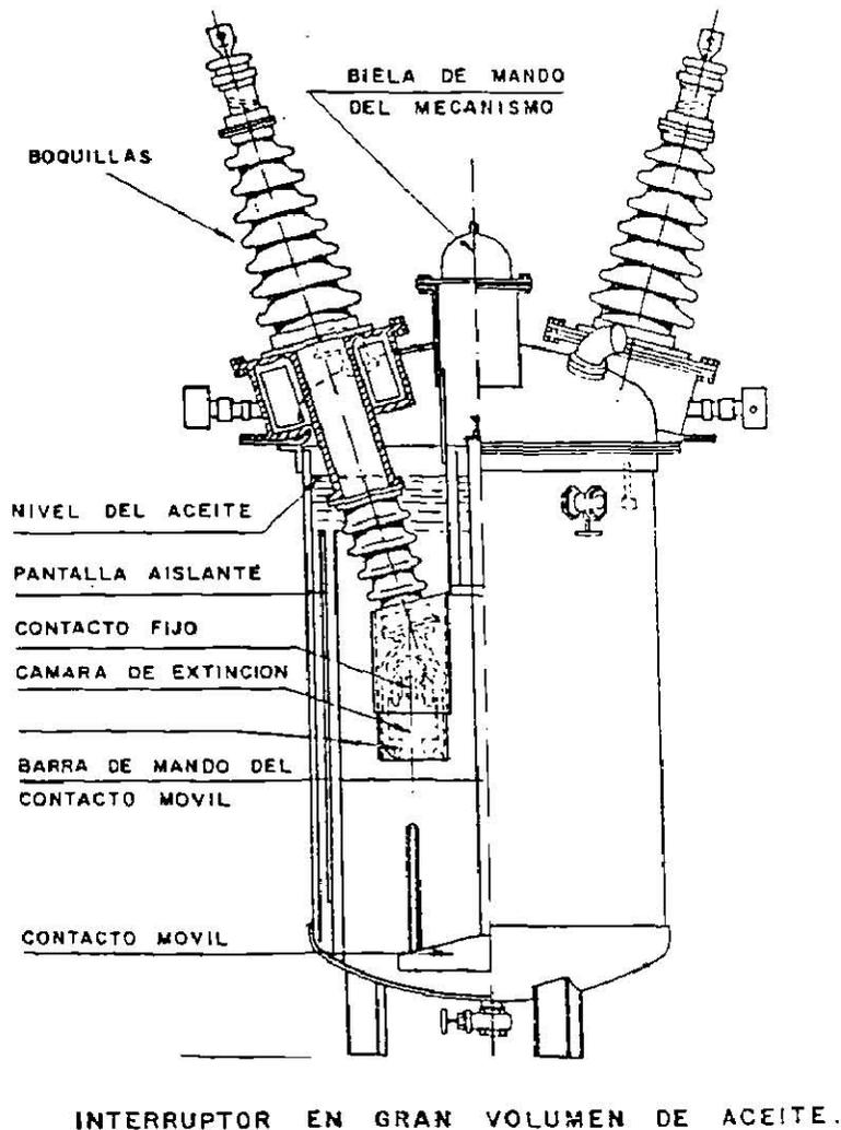
Cuando opera el interruptor figura 1.4 debido a una falla, los contactos móviles se desplazan hacia abajo, separándose de los contactos fijos. Al alejarse los contactos móviles de los fijos se va creando una cierta distancia entre ellos, y en función de esta distancia esta la longitud del arco. El arco da lugar a la formación de gases, de tal manera que se crea una burbuja de gas alrededor de los contactos que desplaza una determinada cantidad de aceite.
