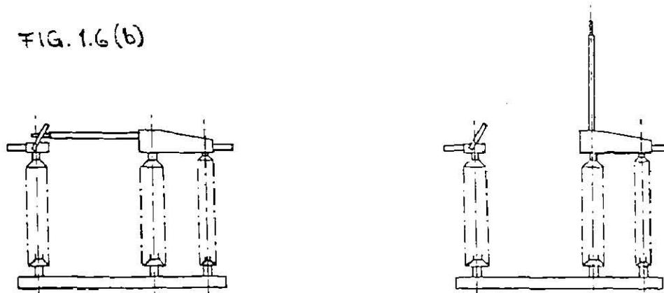
CUCHILLA DESCONECTADORA DE TRES COLUMNAS
