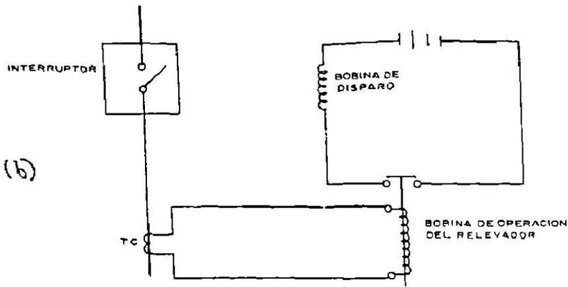
La representación típica del circuito de un relevador
