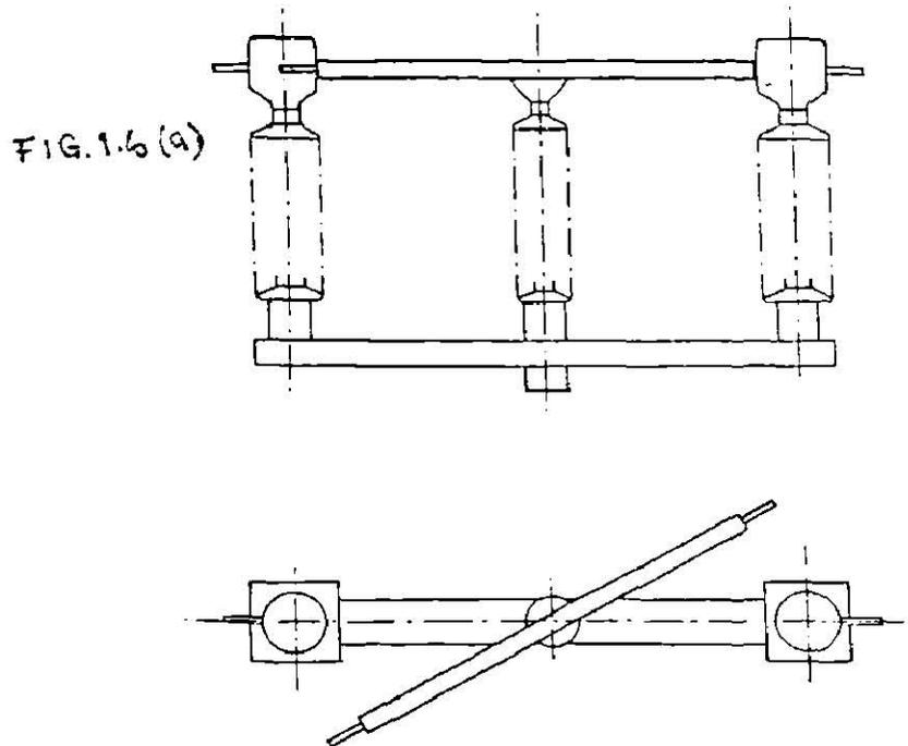
CUCHILLA DESCONECTADORA DE TRES COLUMNAS
