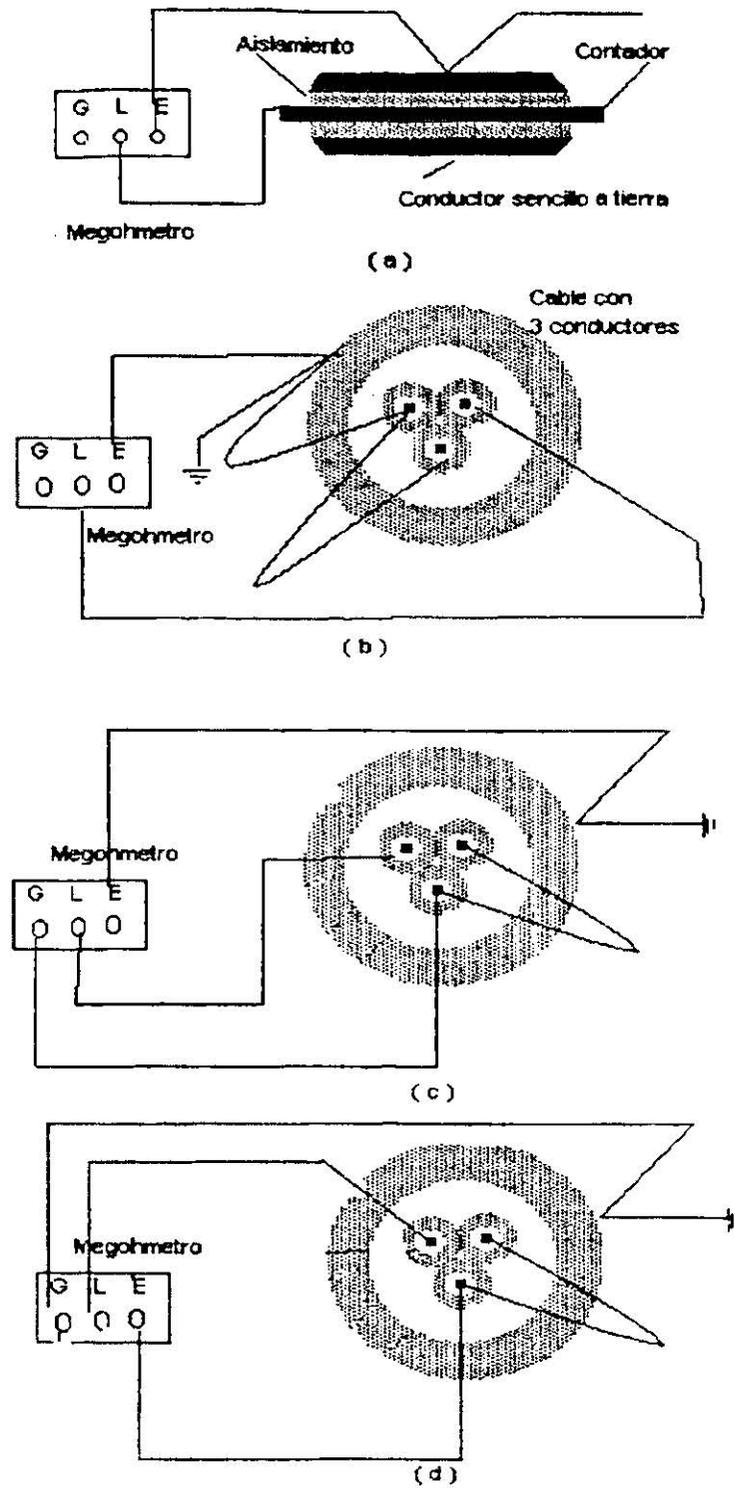
**Figura 2.4** Conexiones de la prueba de cable para la medición de las pruebas de aislamiento: ( a ) Conexiones para la prueba de un conductor sencillo y un conductor a tierra. ( b ) Conexiones para un cable de tres conductores, un conductor y el envoltente a tierra. ( c ) Conexión para un cable de tres conductores, un conductor a la vaina y a tierra y dos conductores protegidos. ( d ) Conexión para un cable de tres, un conductor a todos los otros conductores sin pérdidas por tierra.
