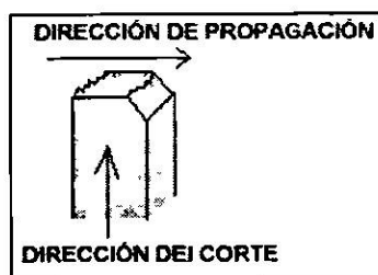
Figura 22. Representación de la probeta fracturada, se observa la dirección de propagación y la dirección del corte.
