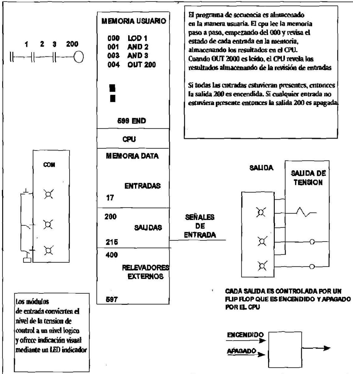
Al final de la exploración del programa el estado de las entradas es transmitido de los módulos de entrada a la memoria. También el estado de salidas en la memoria, es transmitido a los módulos de salida
