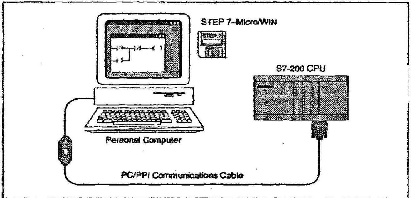
Figura 1-2 Componentes de un sistema Micro PLC S7-200
