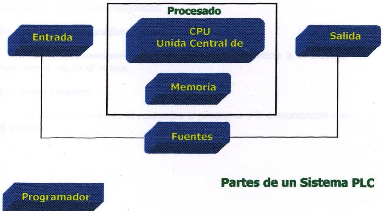
**Partes de un Sistema PLC**
