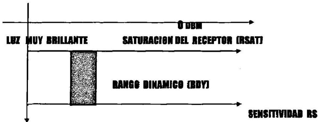
**Fig. 4.13 Parámetros del receptor.**
