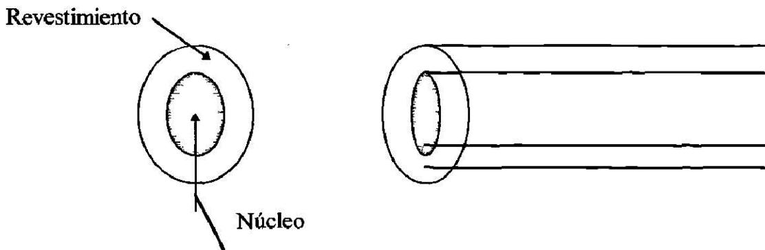
Tanto el núcleo (core) como el revestimiento (cladding) están conformados de ambos vidrio o plástico. Con la combinación de estos materiales se forman tres tipos de Fibra Optica:
