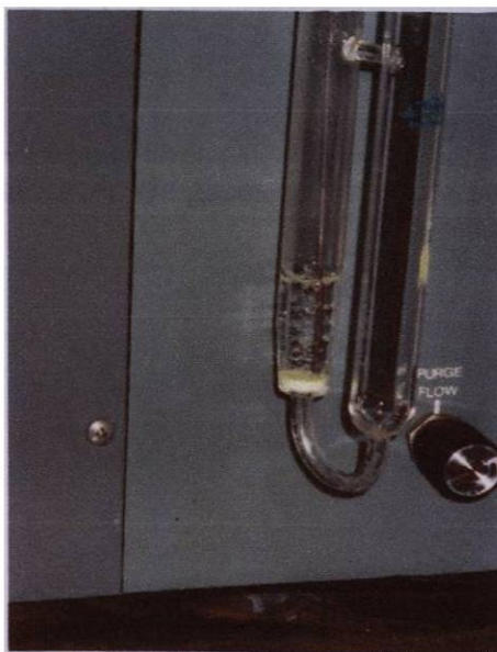
Fig. 14 Concentrador de purga y trampa
