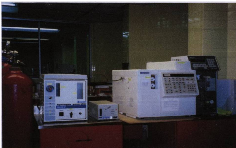
Fig. 15 Cromatógrafo de gases adaptado a una purga y trampa
