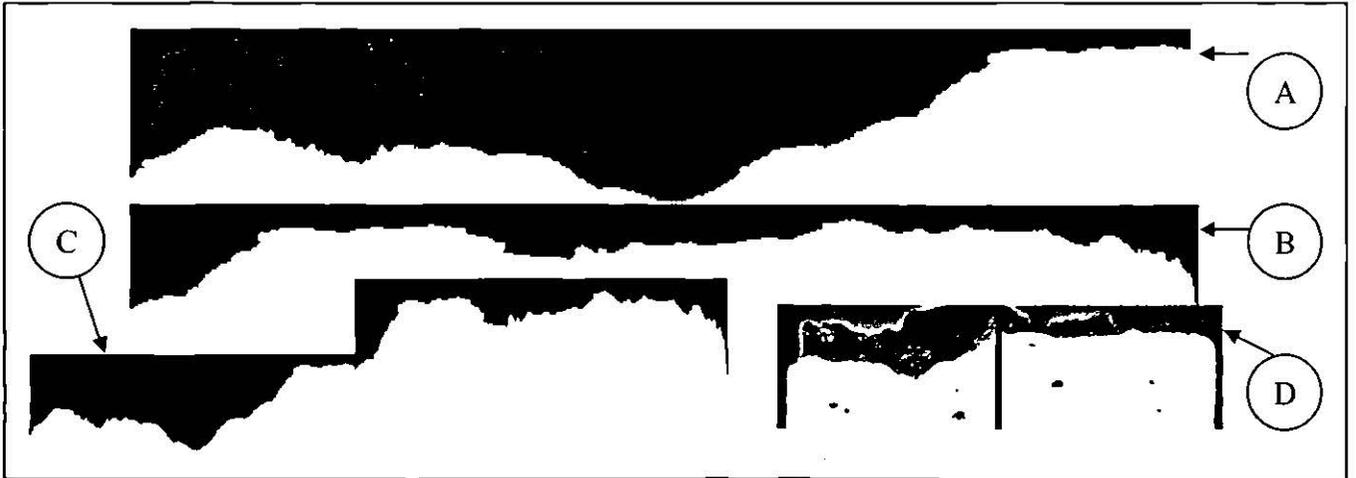
Figura 5.12.- (A) Primeros 512 píxeles de la probeta en el cuadro D, (B) Sigüientes 512 píxeles de la probeta señalada anteriormente, (C) Unión de perfiles [comparar con figura en inciso (D)], (D) Probeta no.3, perfil dividido con una línea para comparar los perfiles con el inciso C.
