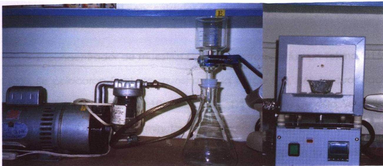
Fig. 15 Sistema de filtración a vacío y mufla
