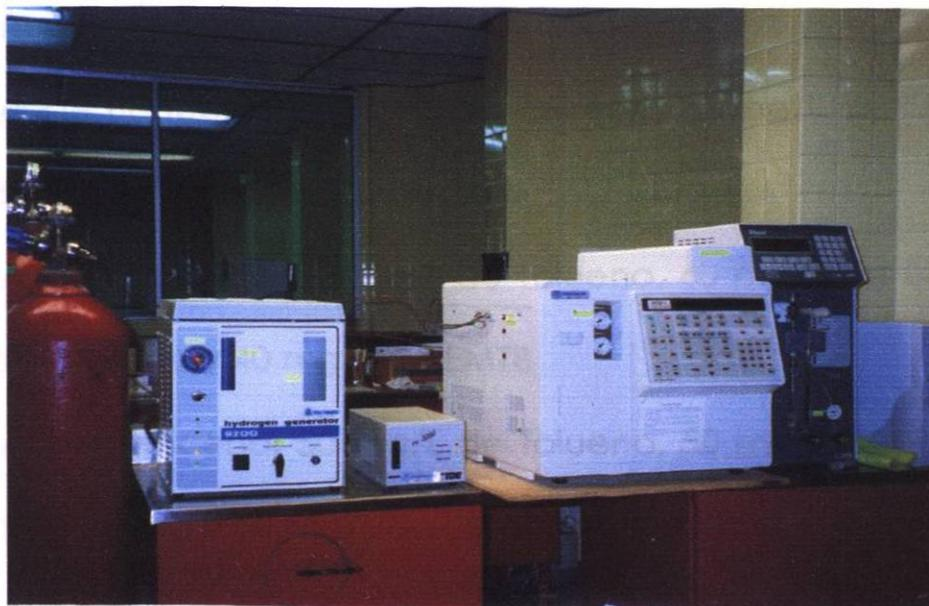
Fig. 18 Cromatógrafo de gases adaptado a una purga y trampa
