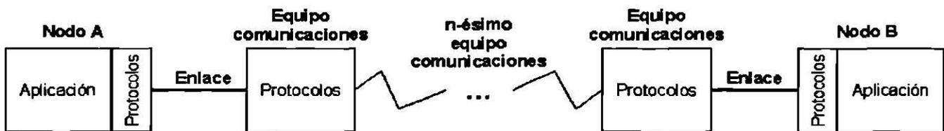
Figura 27. Modelo de red extremo a extremo.
