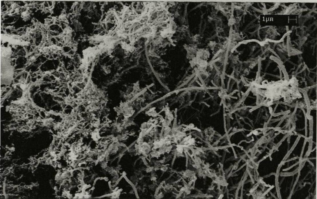
Figura 7.9 Imagen SEM. Nanotubos multicapa a partir del procesamiento por microondas del grafito. Mag. = 10.00K X. 61
