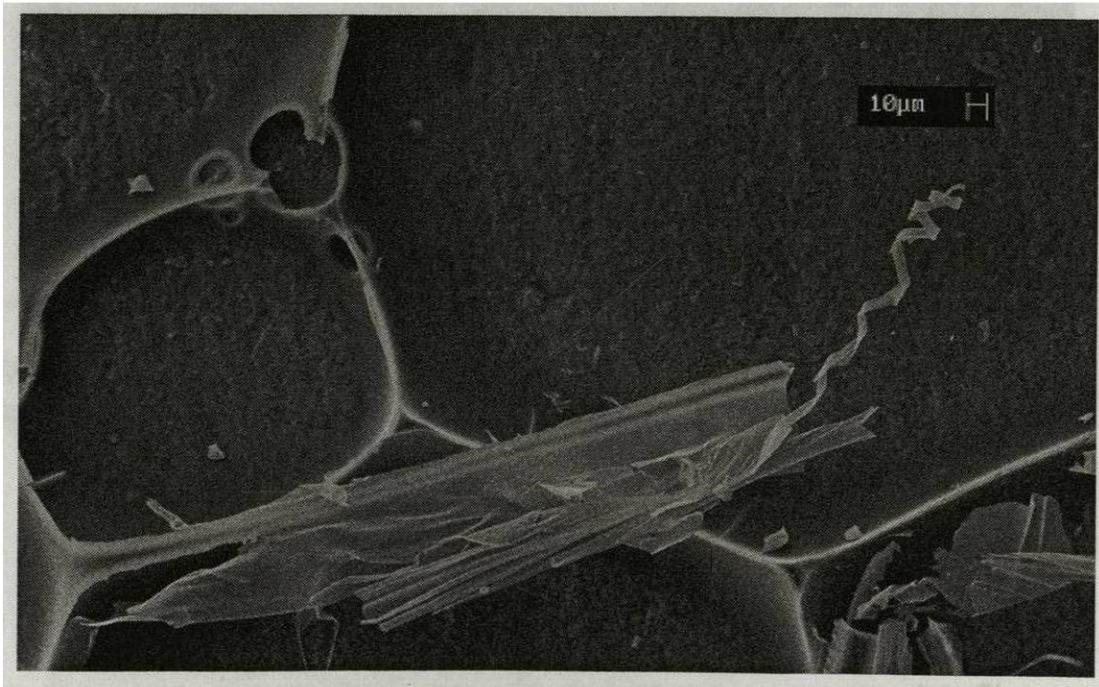
Figura 7.1 Imagen obtenida por SEM de una muestra procesada por microondas de azúcar. Mag. = 600 X.
