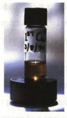
Figura 15. Una ampolla con solución extraída del hollín de carbón.
